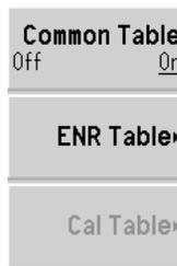
校正と測定に異なる ENR 表を使用するには、**Common Table** メニューキーを押し、**Common Table(Off)** を選択します。図 2-2 を参照してください。
