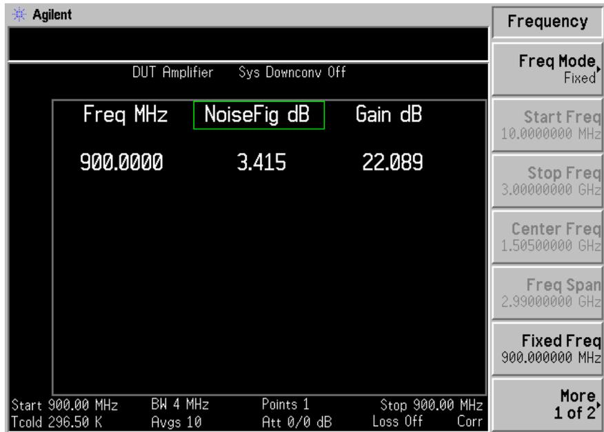
図 1-7 の表示結果は、900 MHz での DUT（テスト対象の機器）の雑音係数と利得を示しています。
